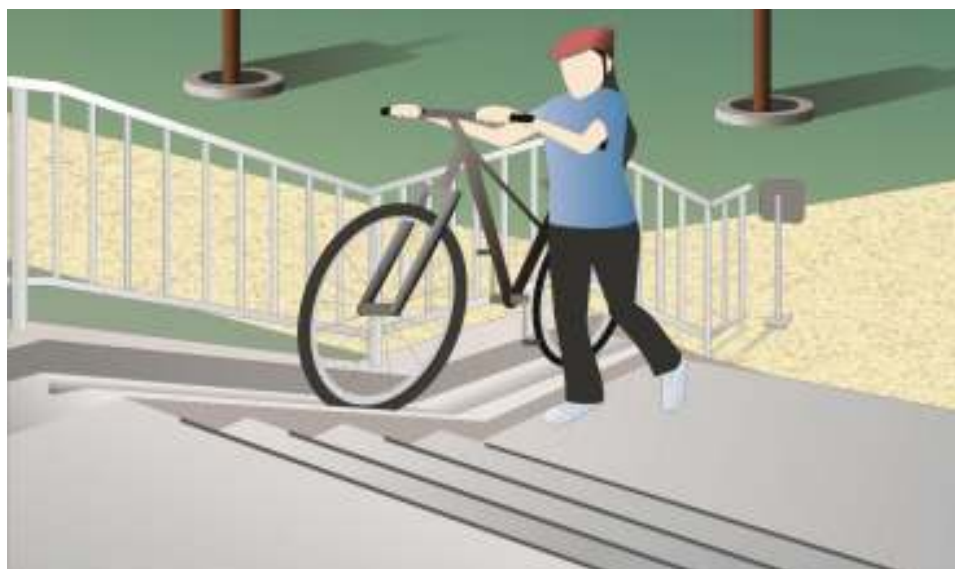
Rampa com guia lateral embutida
