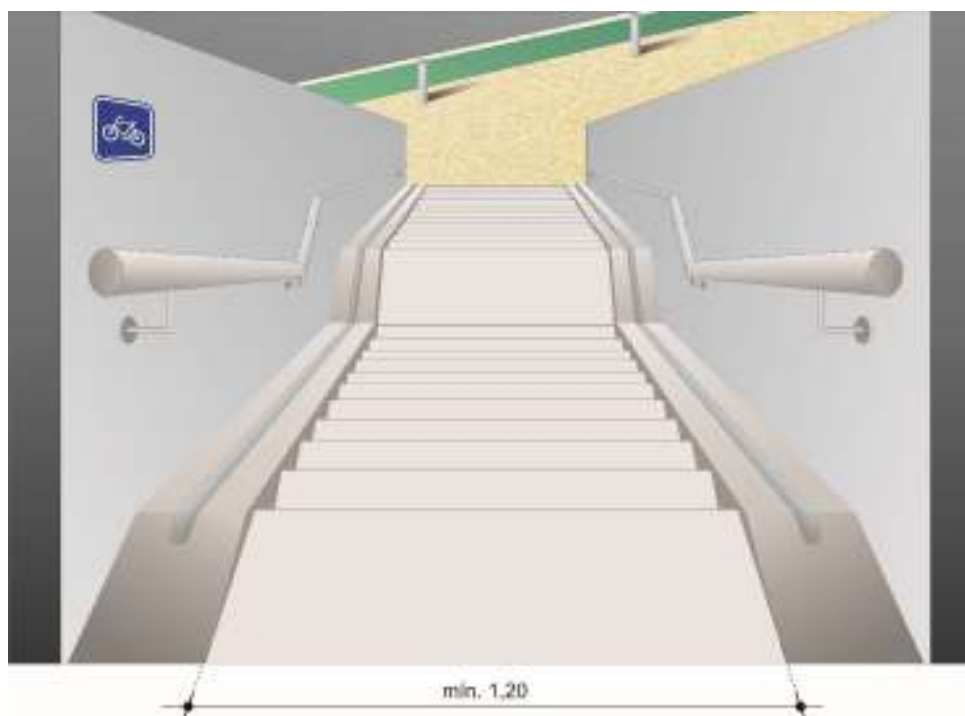
Rampa com guias laterais embutidas
